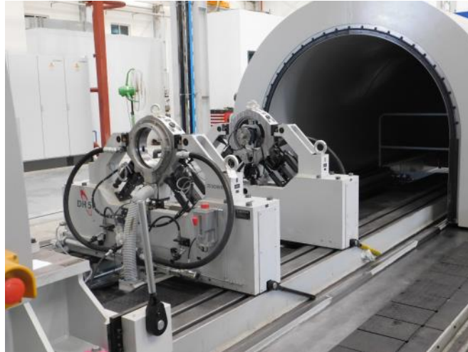
Die neue Hochgeschwindigkeits-Wuchtanlage für die Prüfung von rotierenden Maschinen
